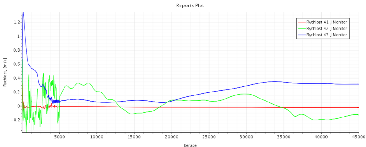
Obrázek 8. Závislost rychlosti na iteraci. Bod 41J je nastaven v prostoru s vypínačem, 42J v prostoru s přípojnici, 43J v prostoru kabelového oddílu.
